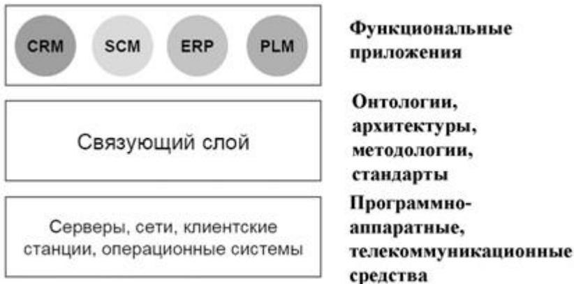
**Рис. 1.** Общая схема компоновки современной КИС
